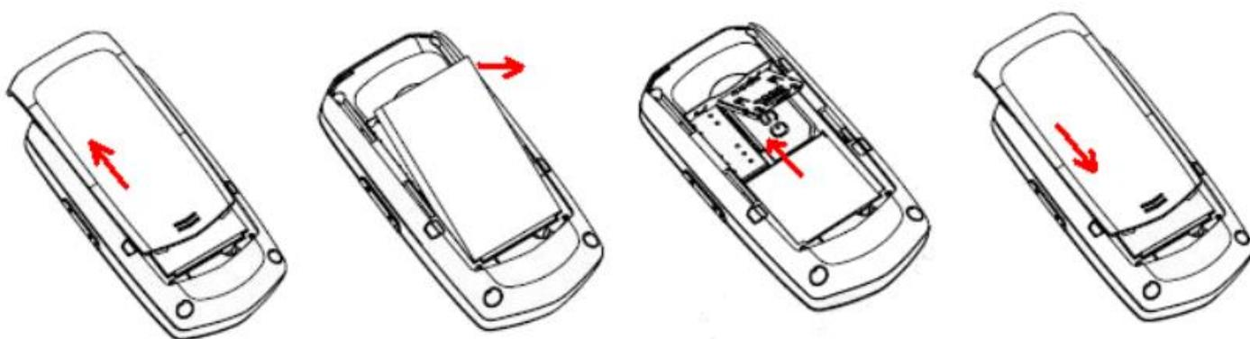
Для установки SIM-карты открутите прилагаемой отверткой два болта на крышке слота SIM карты. Установите SIM карту в слот и снова закройте крышкой.
